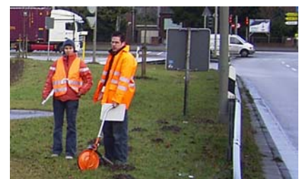
Manuelle Erfassung mit Meßrad und Absicherung durch die Autobahnmeisterei
